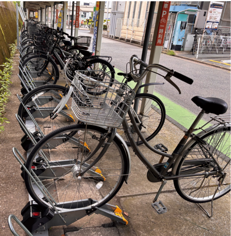
子乗せ自転車や三輪自転車なども駐輪しやすいよう低ラックのみを配置した例。架台の取付ピッチも設置環境に合わせて選択可能となっている。
