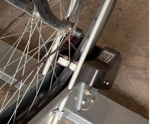
ロック機構は静粛性に優れたモーター式。センサーを搭載し、車両の有無によりロックの開閉を制御。
