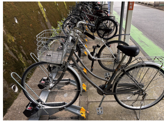
子乗せ自転車や三輪自転車なども駐輪しやすいよう低ラックのみを配置。架台の間隔も設置環境に合わせて選択可能だ。
