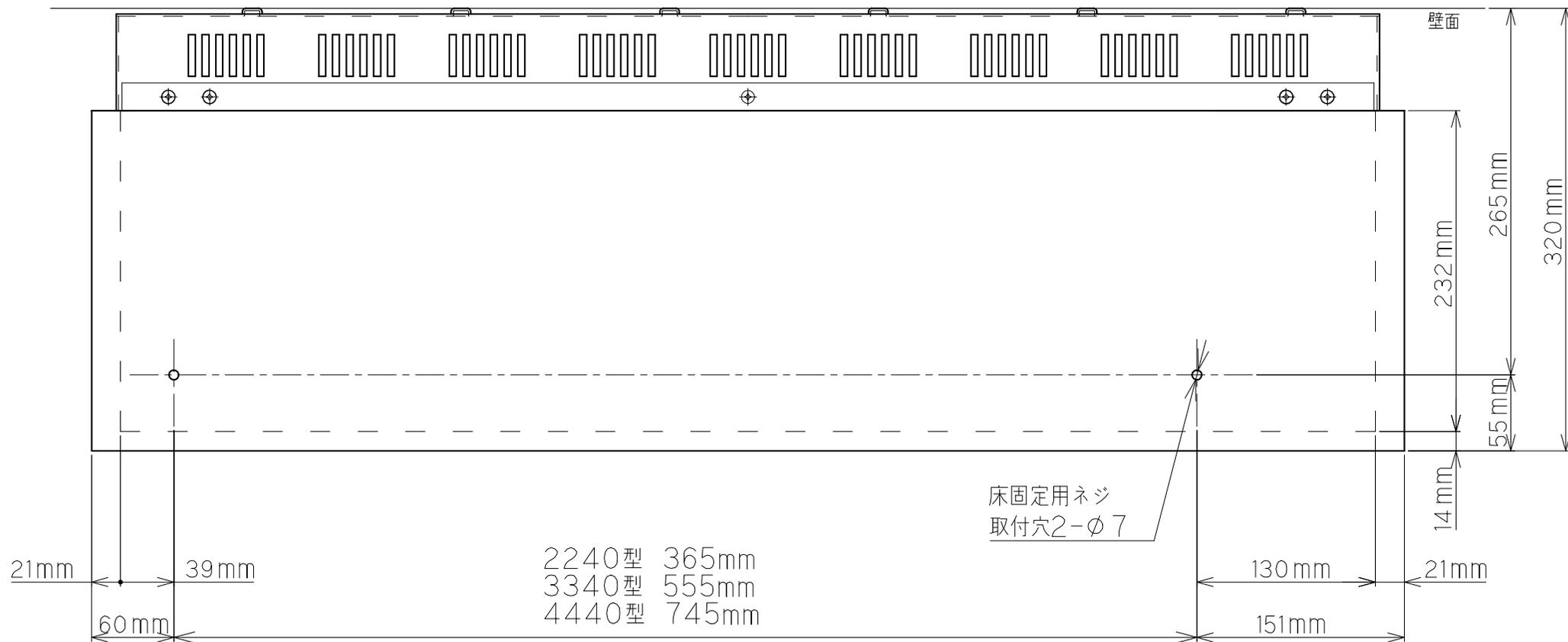
※本図は、製品を上側から見たときの底面の固定用ネジの位置を示しています。
